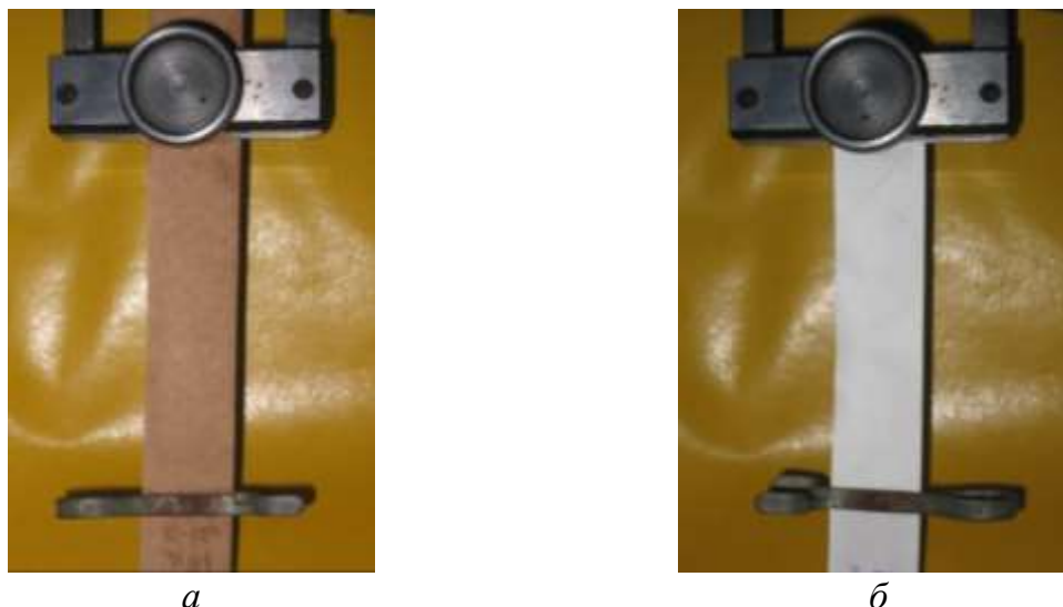
Рис. 1. Образцы при проведении измерений изменения линейных размеров в процессе сушки: а – крафт-лайнера массой 120 г/м 2 , б – обойной бумаги 110 г/м 2
