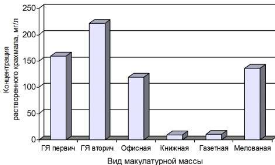
Рис. 4. Концентрация растворенного крахмала в бумажной массе из различных видов макулатуры
