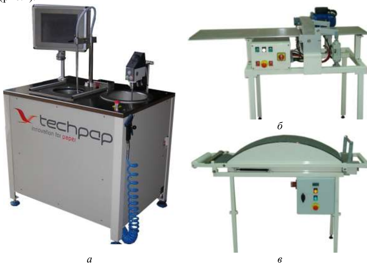
Рис.1. Динамический листоотливной аппарат TechPap: а – формующее устройство; б – пресс; в – сушиллка
