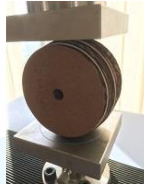
Тест торцевого сжатия на испытательном стенде
