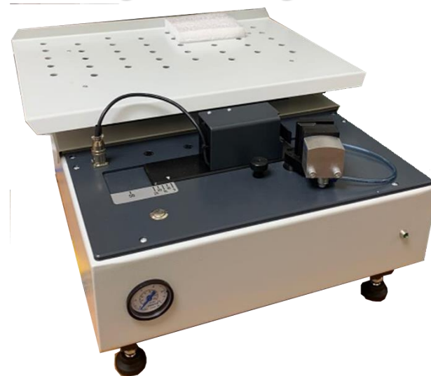
прибор для определения сопротивления изгибу «ИТС 7003»
